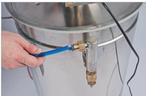
Таким же образом подключите к сливу нижний клапан аварийного сброса давления.
