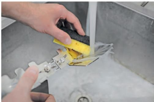
Миксер пивоварни допускается мыть только в разобранном состоянии. Открутите шток от мотора миксера и разберите мешалку. Шток и мешалку допускается мыть стандартным бытовым моющим средством. Корпус мотора миксера при необходимости протереть влажной, хорошо отжатой мягкой губкой.
